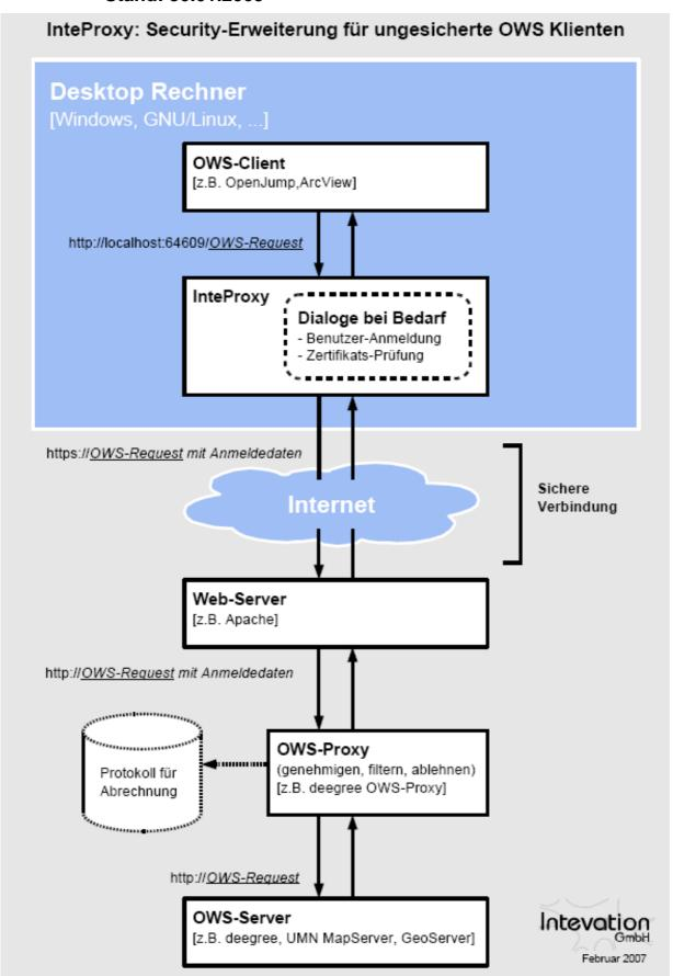
Die nachfolgende Abbildung zeigt schematisch das Konzept zur Erweiterung der Sicherheitslösung (OWS Proxy, InteProyx) um eine Komponente zur Abrechnung (Accounting) und statistischen Auswertung (Statistics) von Anfragen mittels OGC konformer Webdienste (OSAAS - OWS Statistics and Accounting System).
